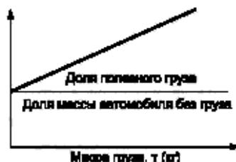
Рисунок 11 — Потребление топлива грузовым автомобилем в зависимости от перевозимого груза
